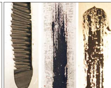
obr. 6: různé projevy adheze a poruch
